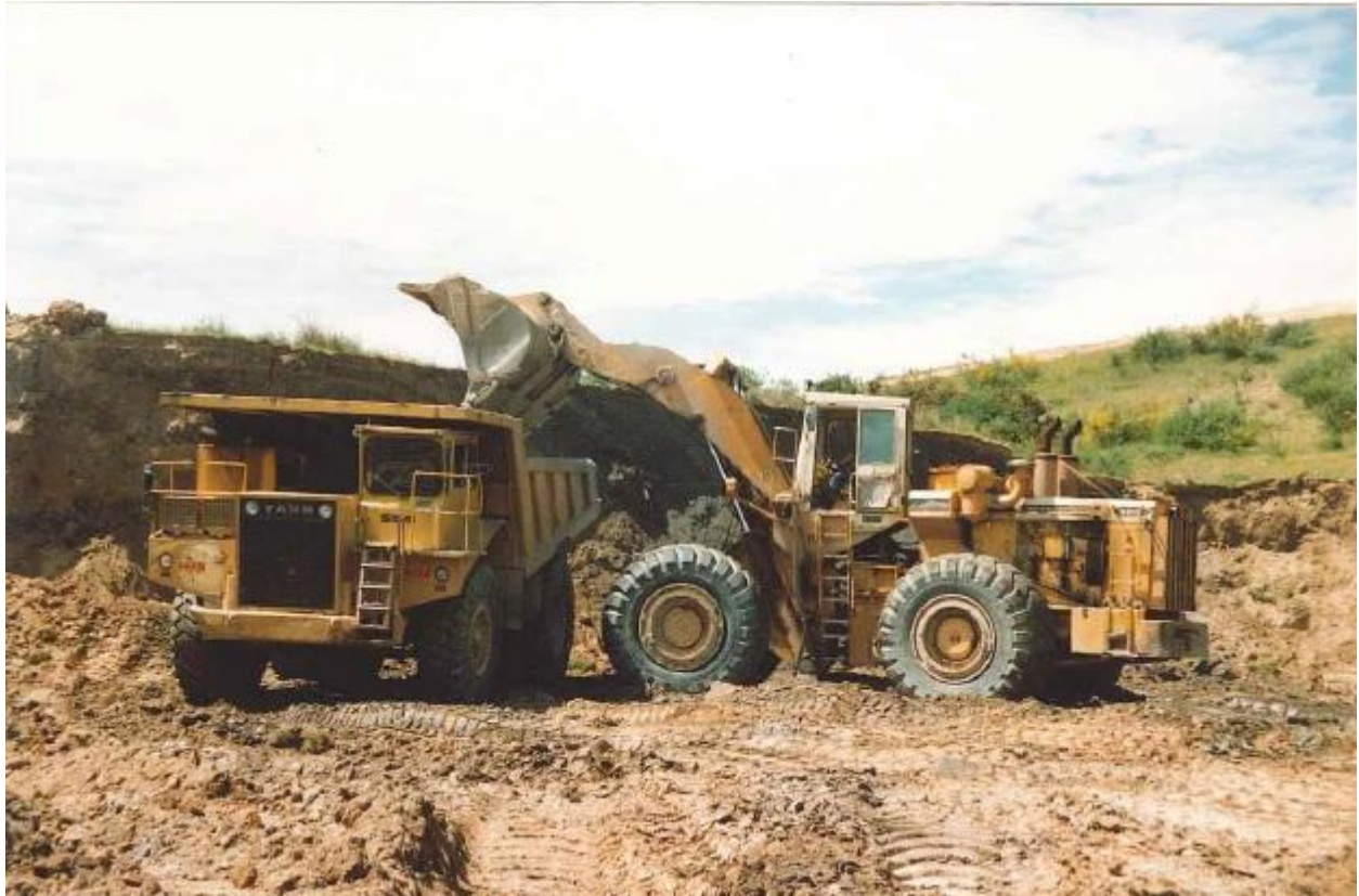
Figure 21: Chargement au stérile d'un dumper FAUN K555 (cliché AREVA)
