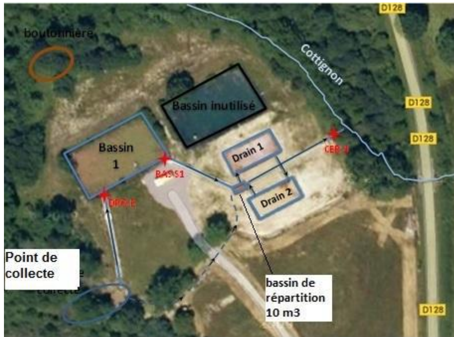
Figure 44 : Cheminement des eaux entre le point de collecte et le bassin de pré-décantation
