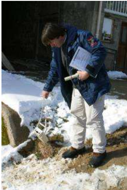
4 La CRIIRAD (B Chareyron) mesure le niveau de radiation émis par du minerai uranifère dans la cour de la ferme de Moulin Poyet (Photo Jeff Rachel, janvier 2004) /
